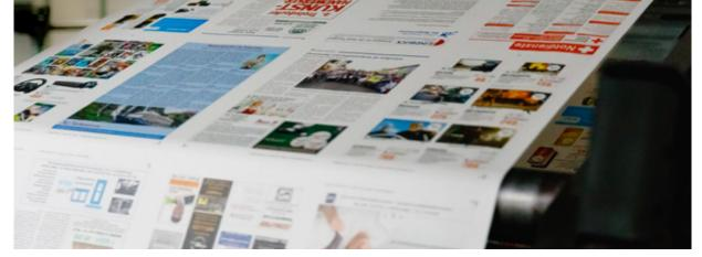
Rollenoffsetdruck: 35.000 Zeitungen pro Stunde | 64 Seiten | Leimung | Rundumbeschnitt
